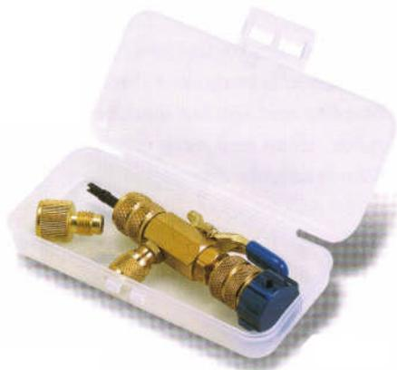
Cet outil permet de démonter et de remplacer les valves Schrader à l'intérieur de raccord 1/4" Flare et 5/16" Flare, lorsque le circuit de fluide frigorigène est sous pression.
