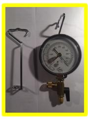
Vacuomètre précision class 1.6 En mbar / Pa = x 100
